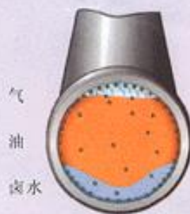
管道断面表明VCI在界面、液相、气相中的保护作用。
