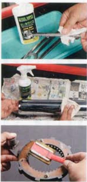
ウェットティッシュに染み込ませた薬液で、金属表面に付着した油やグリスの汚れを洗浄した後に、金属表面を防錆保護するツールワイプ。
