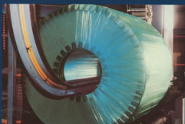
VCI-126. Embalaje automático bobinas de chapa de acero laminado
