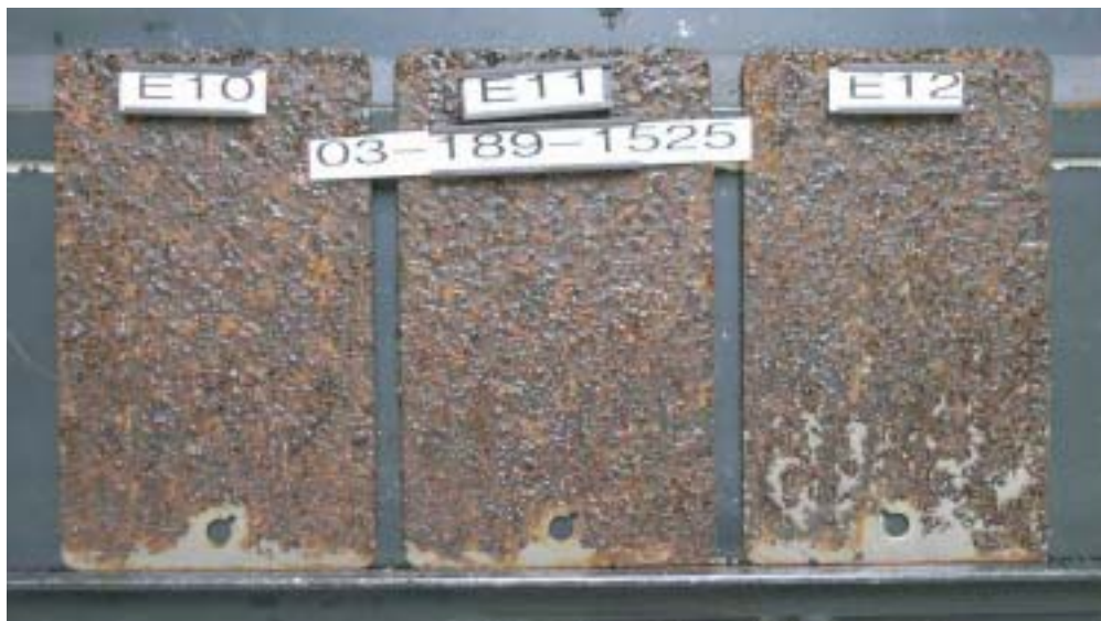
Panels E10, E11, E12 after 40 cycles in GM 9540P
