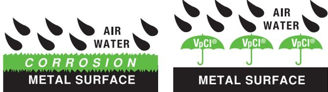
Bullfrog® VpCI® verbinden sich elektrochemisch mit Metalloberflächen und bilden einen "Schirm" der Luft und Feuchtigkeit hält und so Korrosionsschutz bietet.
