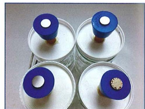
Test VIA - ispitivanje učinkovitosti zaštitnog filma VpCl
