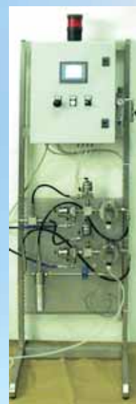
Sistema automatico di miscelazione delle vernici liquide pluri-componenti con metodo proporzionale
