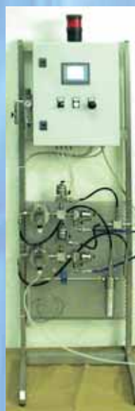
Sistema automatico di miscelazione delle vernici liquide pluri-componenti con metodo proporzionale
