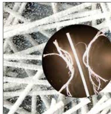
Monofilamento de Polipropileno, fibras contendo MCI® reduz fissuras de retração em concretos novos.
