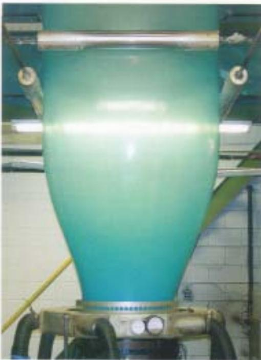
コーテック社の高水準フィルム、バッグ製造
