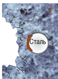
Удалить разрушенный бетон из конструкции
