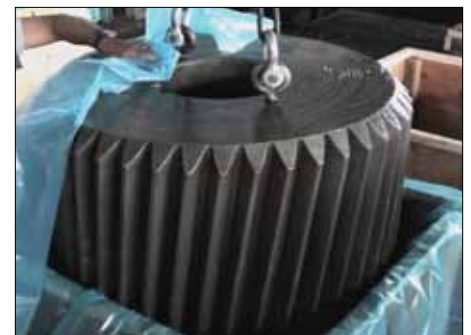
Fotografija: Thomas Simone Company Izdelek: VpCI®-126, 369D Papir Mill Gear, prevlečen z 369D in zavrt v moder VpCI®-126 Lokacija: Ohio, ZDA
