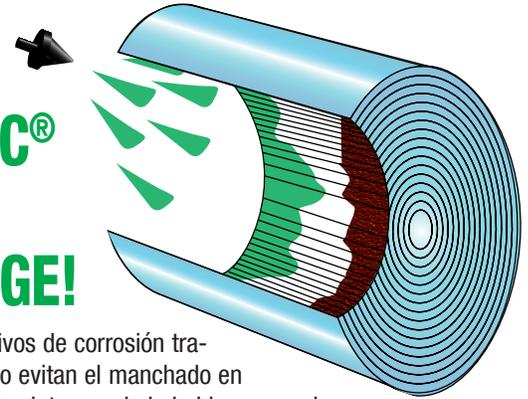
Los preventivos de corrosión tradicionales no evitan el manchado en las superficies internas de la bobina, pero el VpCI® sí lo protege. La humedad y la condensación penetran rápidamente en la bobina provocando un ambiente altamente corrosivo en su interior. La corrosión y el manchado pueden desarrollarse en minutos bajo estas condiciones. Los VpCI® emiten sus Inhibidores de Corrosión fase Vapor donde la humedad y los agentes corrosivos penetran, para brindan protección anticorrosiva completa.
