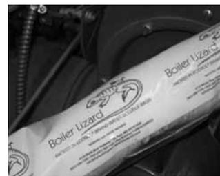
El inhibidor de la corrosión en fase vapor en polvo se sirve en bolsas hidrosolubles de polivinilalcohol (PVA).
