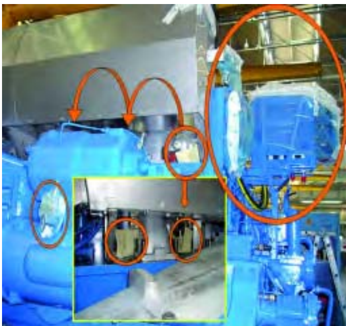
Motor de Barco en Trieste, Italia, protegido con espumas VpCI (como se muestra en la imagen) listo para ser transportado por el océano.
