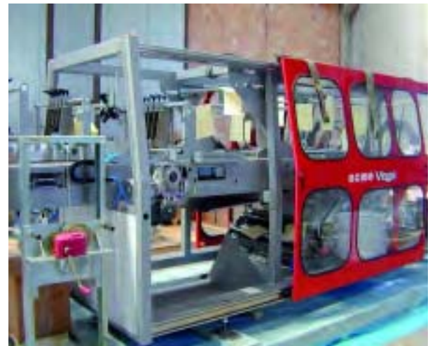
Protección contra la corrosión en transporte usando Espuma de Cortec VPCI® de maquinaria de retractilado para botellas PET.
