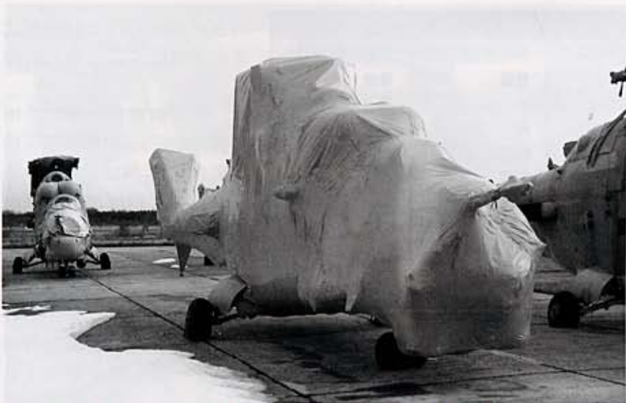
(上) 即使包裝破損或封閉不完全，氯化防蝕封存仍具高度防蝕效果。
