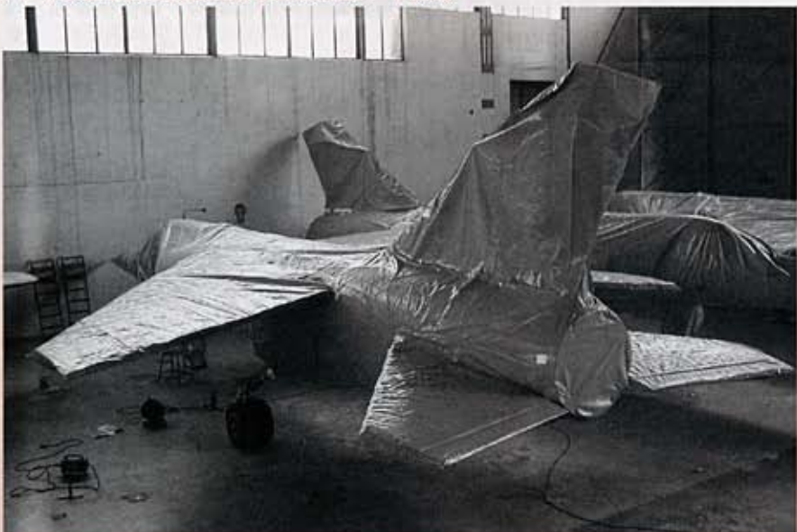
(下) 以氯化防蝕技術封存的法製幻象 F-1 戰機。
