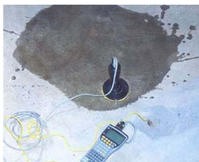
以 GalvaPulse 儀器測量地坏的鏽蝕情況
