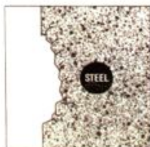
去除鬆動混凝土
