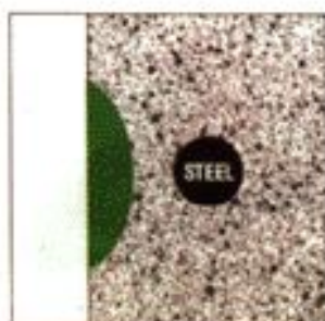
修補處含MCI
