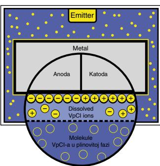
Cortec VpCI® emiteri dizajnirani su tako da štite od korozije opremu, komponente i rezervne dijelove dok su u zatvorenom prostoru koji nije izložen strujanju zraka. VpCI® emiteri otpuštaju emitiraju isparavajuće inhibitori korozije koji se elektrokemijski vežu na metal i stvaraju zaštitni molekularni sloj na površini metala. Molekularni zaštitni sloj osigurava zaštitu i pomaže smanjenju korozije uzrokovanog vlagom u zatvorenom prostoru.
