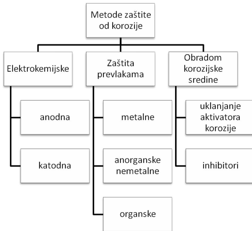
Slika 6. Metode zaštite od korozije
