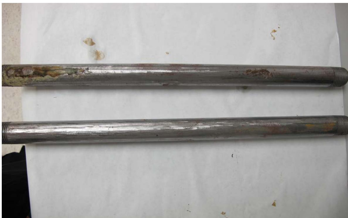
Slika 37. Cijevi sa i bez VpCI-658 ispod staklene vune nakon 168 sati u klima komori
