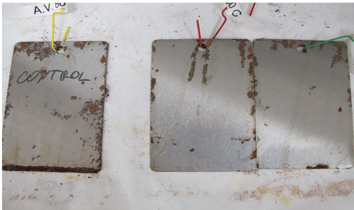
Slika 31. Pločice sa VpCI-658 grijane 72 sata na 80 °C; nakon 336 sati u klima komori
