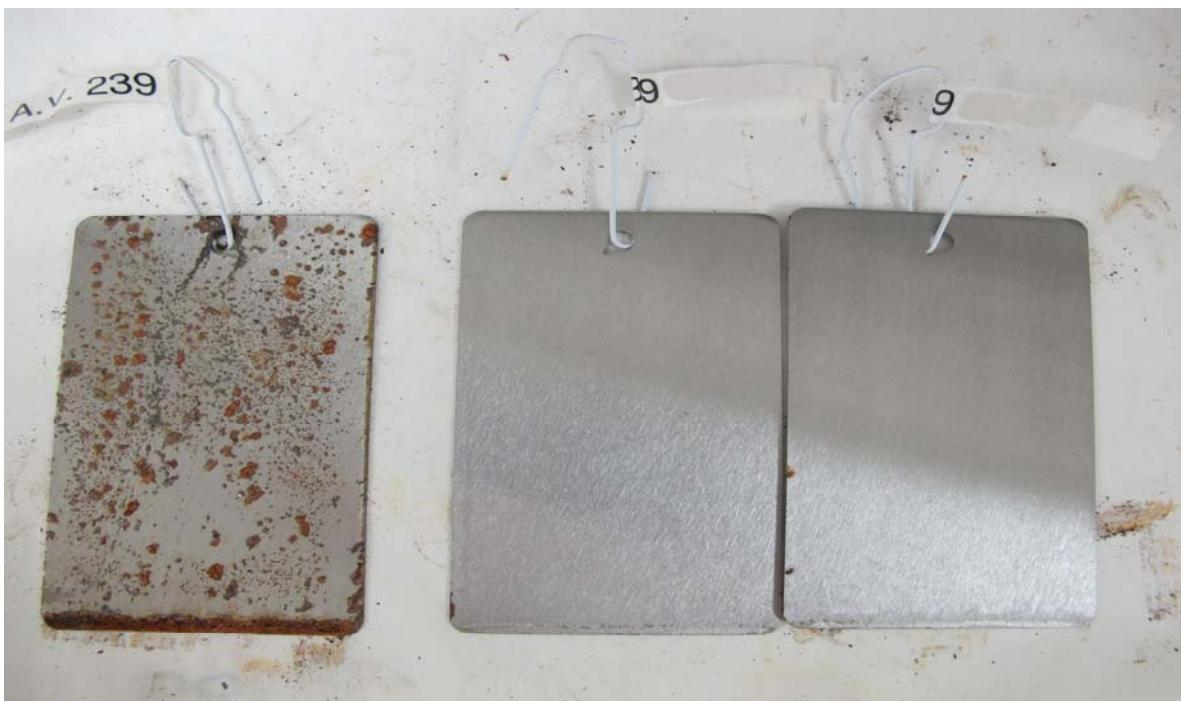
Slika 34. Netretirane pločice sa VpCI-239 nakon 144 sati u klima komori
