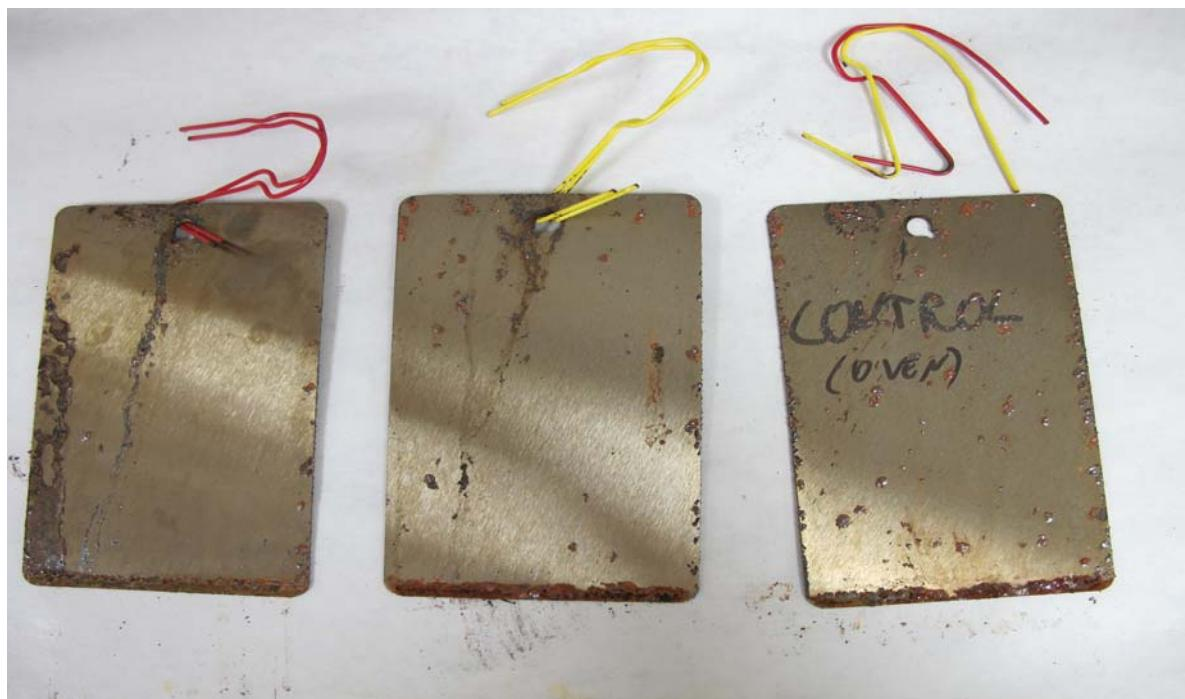
Slika 26. Pločice sa VpCI-658 grijane 168 sati na 150 °C; nakon 264 sati u klima komori
