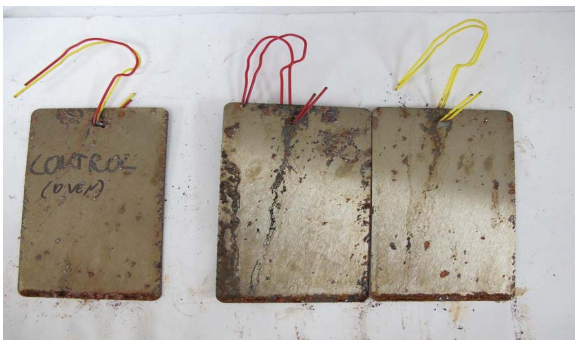
Slika 27. Pločice sa VpCI-658 grijane 168 sati na 150 °C; nakon 504 sati u klima komori
