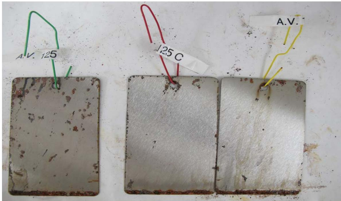
Slika 29. Pločice sa VpCI-658 grijane 72 sata na 125 °C; nakon 336 sati u klima komori
