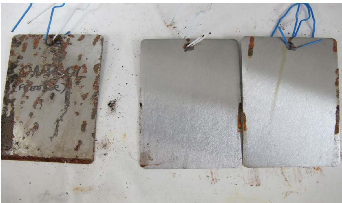
Slika 33. Pločice sa VpCI-658 hlađene 168 sati na -35 °C; nakon 504 sata u klima komori
