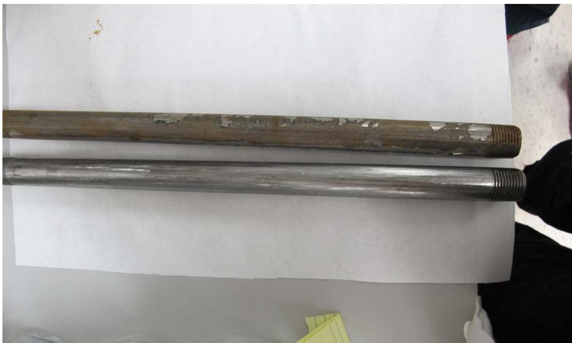
Slika 36. Cijevi sa i bez VpCI-658 ispod PUR pjene nakon 168 sati u klima komori
