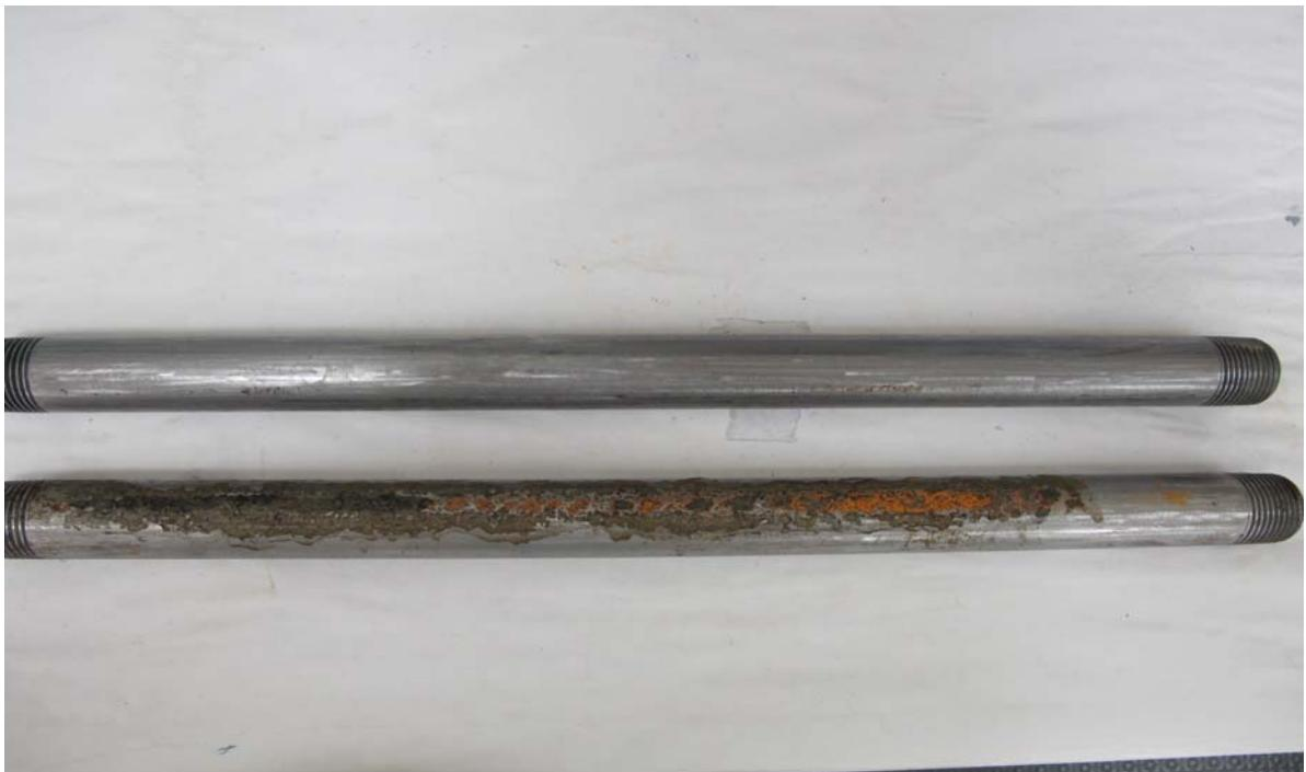
Slika 38. Cijevi sa i bez VpCI-239 ispod PUR pjene nakon 168 sati u klima komori
