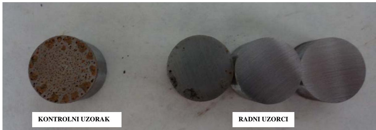
Slika 41. Rezultati testiranja VpCI®-126 na čeliku
