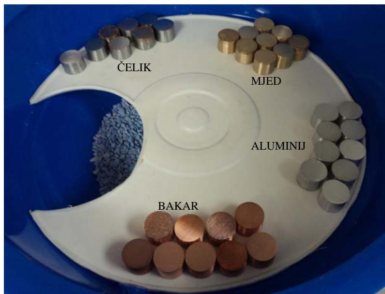
Slika 26. Uzorci metala korišteni u eksperimentu
