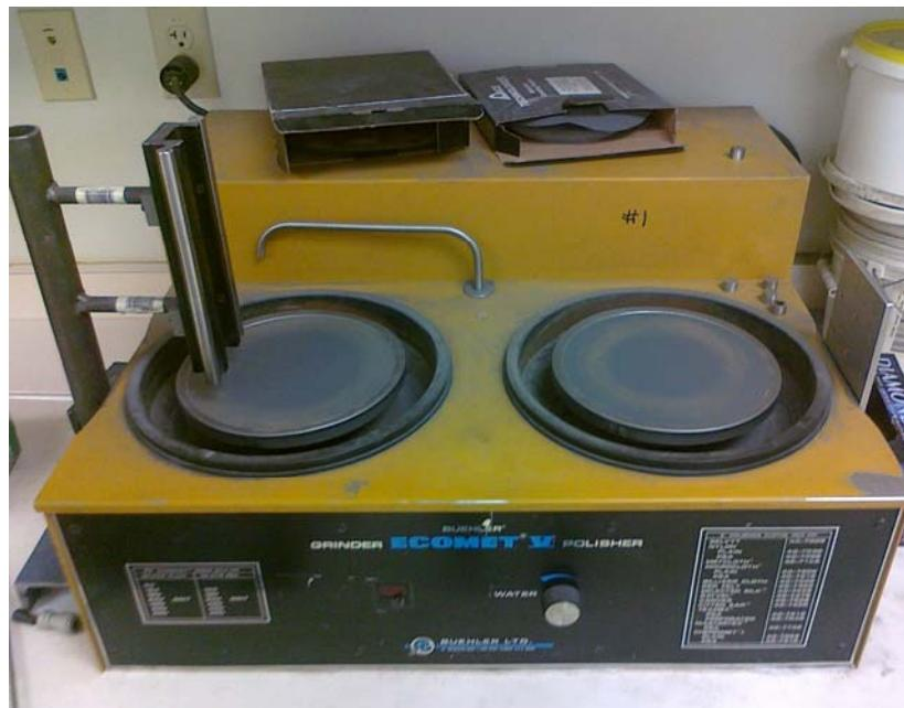
Slika 27. Uređaj za brušenje metalnih uzoraka
