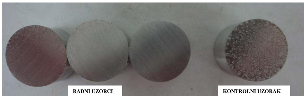
Slika 52. Rezultati testiranja VpCI®-309 na aluminiju
