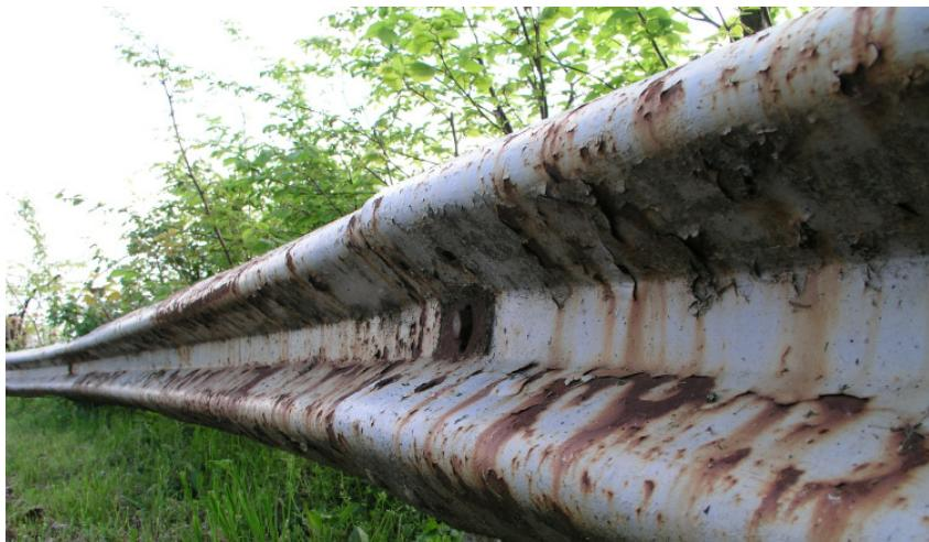
Slika 20. Oštećenje nastalo djelovanjem atmosferske korozije <sup>[37]</sup>
