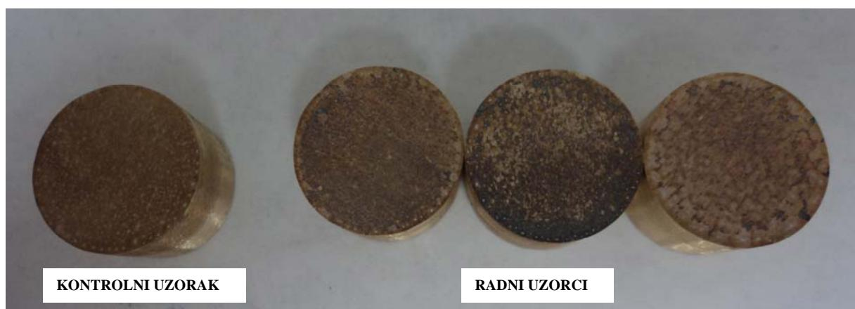
Slika 50. Rezultati testiranja VpCI®-308 na mjeri
