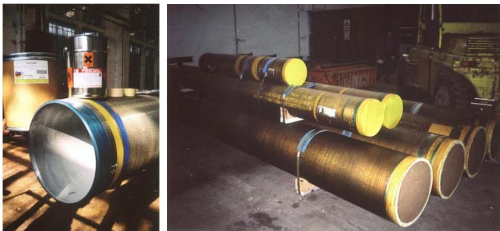
**Slika 2.** Privremena zaštita unutrašnjosti cijevi praškastim inhibitorima korozije
