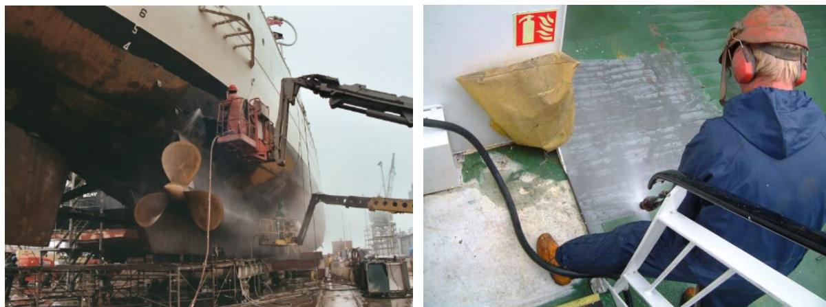
**Slika 12.** Priprema površine vodenim mlazom [7, 8]
