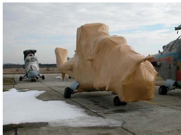
**Slika 7.b** Primjena inhibitora korozije za zaštitu borbenih letjelica [5]
