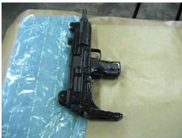
**Slika 7.a** Primjena inhibitora korozije za zaštitu pješačkog naoružanja [5]
