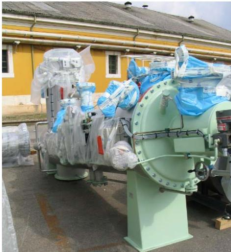
**Slika 11.a** Zaštita brodske opreme najlonskim omotom bez inhibitora
