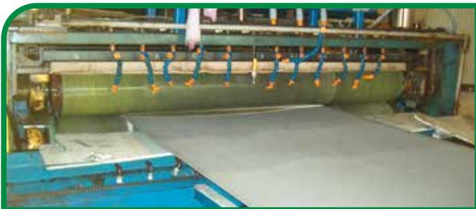
**PROTECCIÓN CONTRA LA CORROSIÓN DE BOBINAS DE ACERO**
