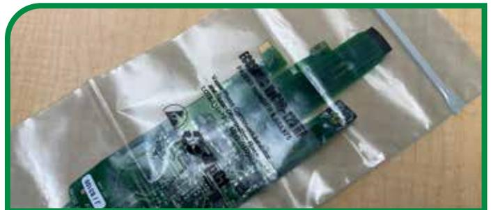
**INCORPORACIÓN DE PROTECCIÓN CONTRA LA CORROSIÓN EN BOLSAS ESD PARA ELECTRÓNICA**
