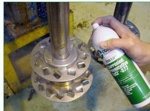
**VpCI®-377** - é um concentrado à base de água concebido como um completo substituto para preservativos à base de óleo, para proteção interna de equipamentos e componentes. VpCI®-377 é um líquido para prevenir a corrosão que atende aos requisitos antipoluição.
