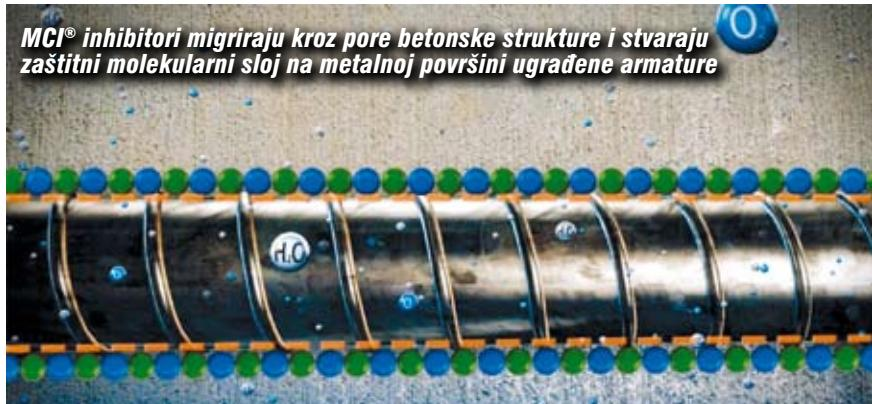
njem dovodi do oksidacije i korozije čelika te na taj način struktura postupno gubi nosivost.'
