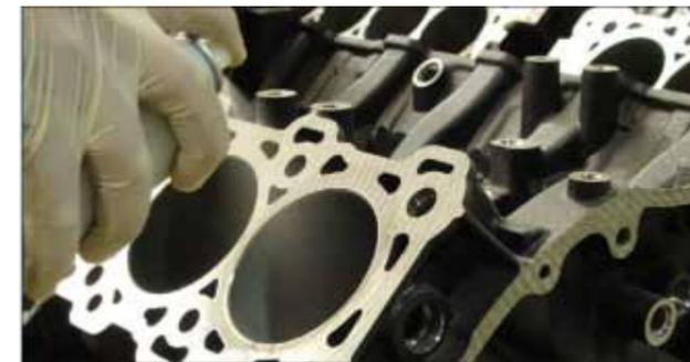
Exemple de protection de pièces mécaniques par vaporisation
