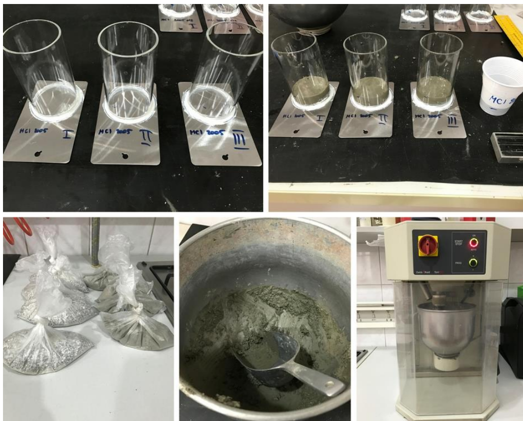
Slika 10. Miješanje morta za pripremu uzoraka
