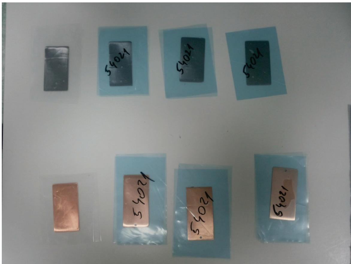
Slika 5.15 Uzorci od bakra i ugljičnog čelika postavljeni u VpCI – 126 film
