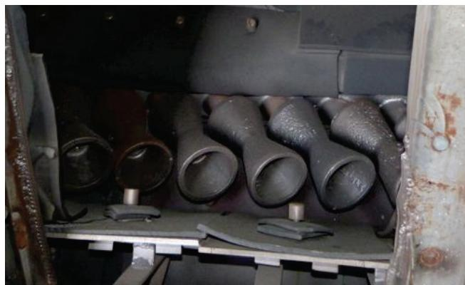
*Slika 3.4 Primjer uklanjanja produkata korozije sačmarenjem [7]*
