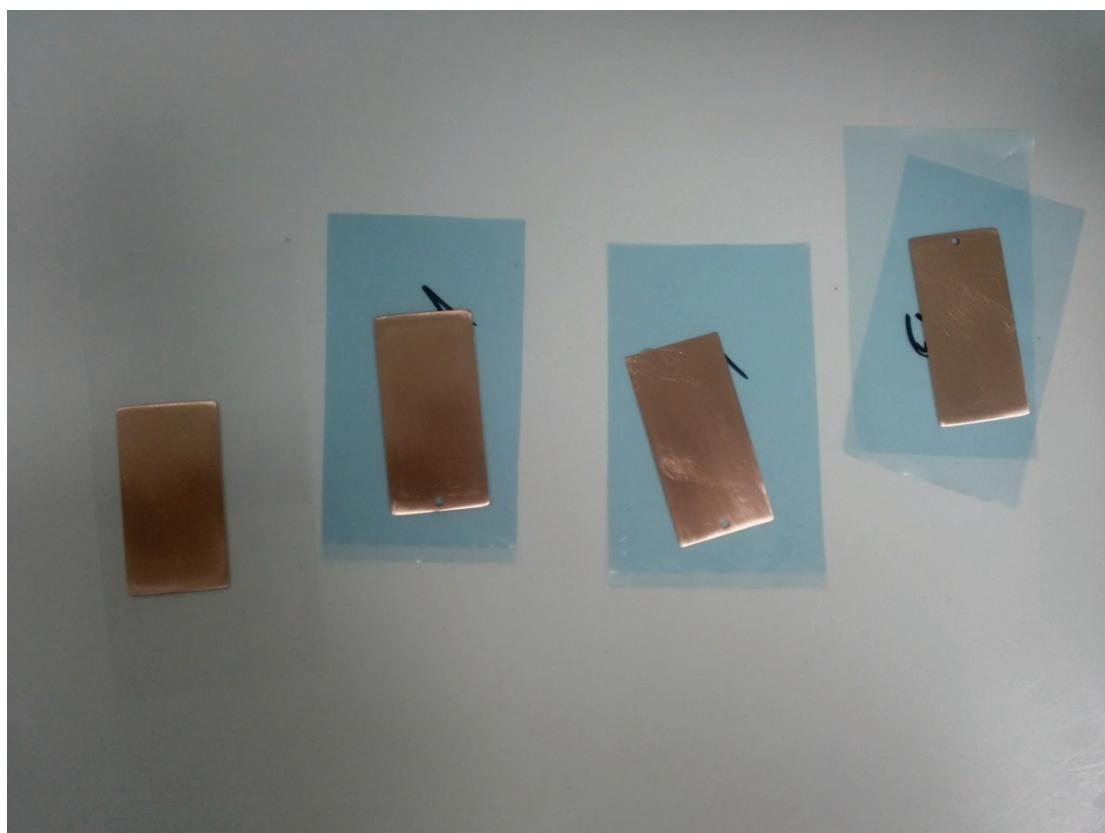
Slika 5.13 Uzorci od bakra pripremljeni za ispitivanje
