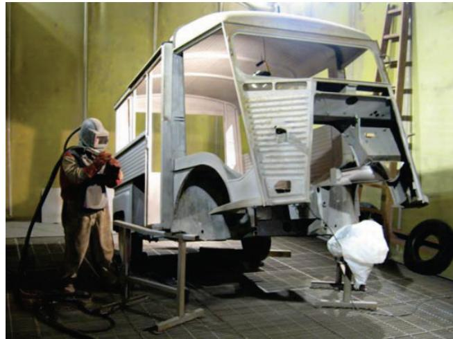
*Slika 3.3 Primjer uklanjanja produkata korozije pjeskarenjem [9]*
