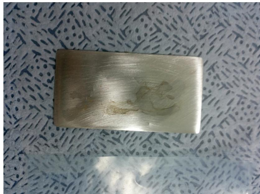
*Slika 5.17 Kontrolni uzorak ugljičnog čelika nakon 2 sata mirovanja*
