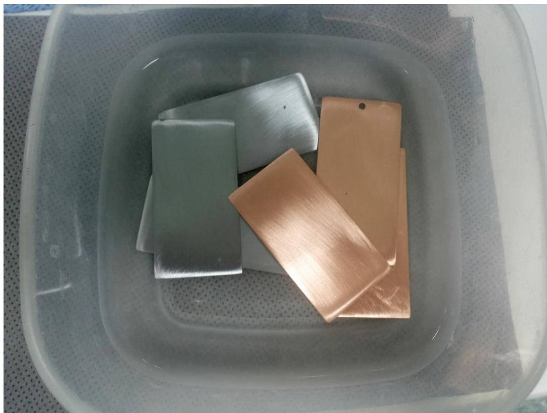
5.12 Uzorci od ugljičnog čelika i bakra uronjeni u etanol
