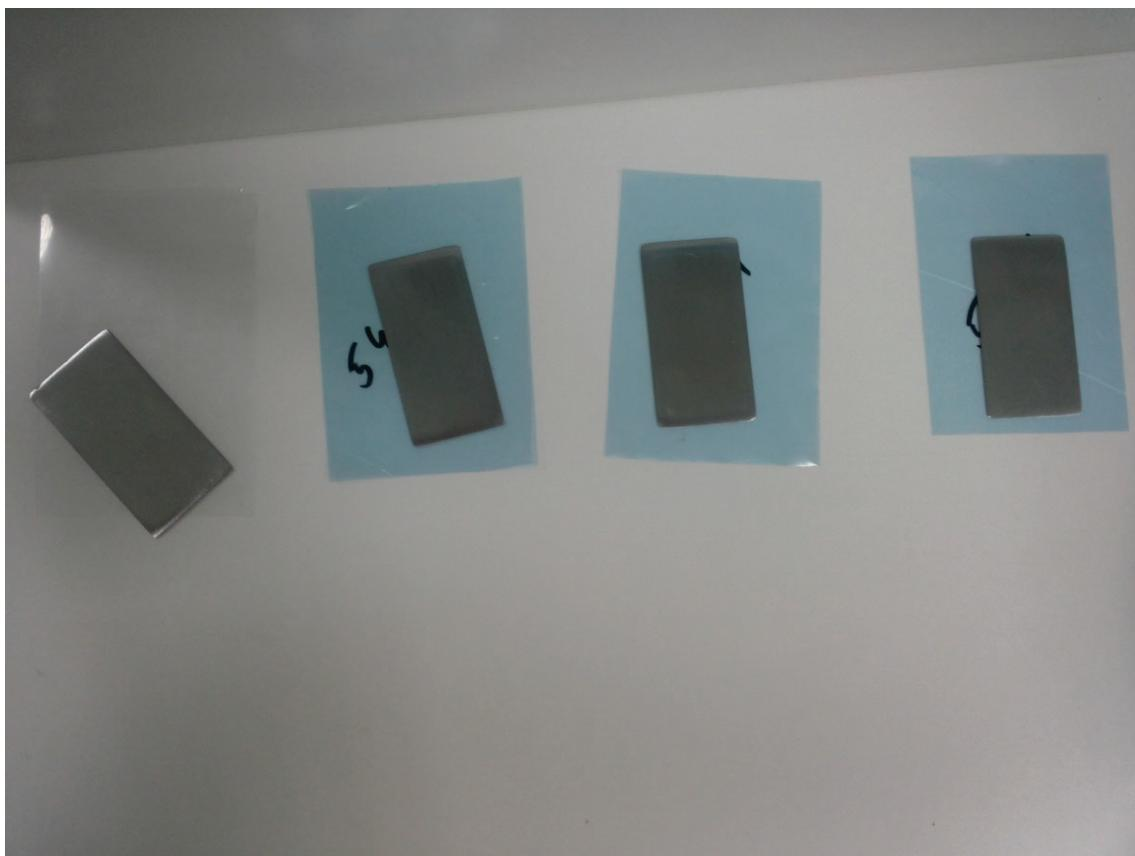
*Slika 5.14 Uzorci od ugljičnog čelika pripremljeni za ispitivanje*
