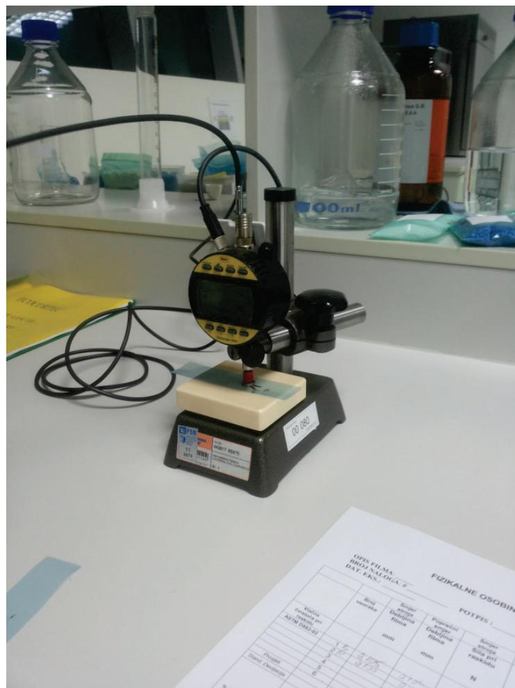
Slika 5.2 Mjerenje debljine filma pomoću komparatora
