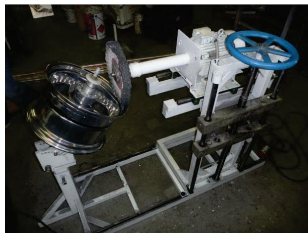
*Slika 3.2 Primjer uklanjanja produkata korozije poliranjem [7]*
