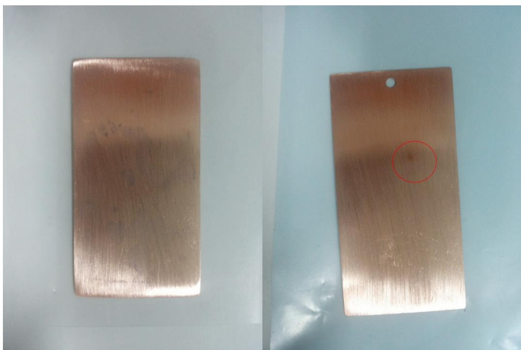
*Slika 5.19 Kontrolni i ispitni uzorak bakra na kojima je vidljiva korozija nakon 4 sata mirovanja*
