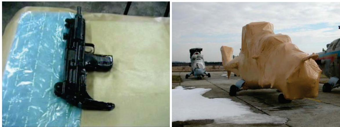
Slika 4.3 Primjena hlapljivih inhibitora korozije u zaštiti vojne opreme [11]
