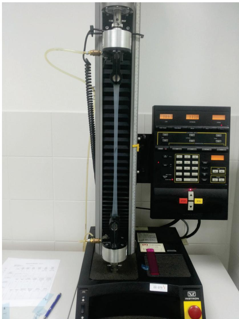
Slika 5.3 Rastezanje VpCI – 126 folije na kidalici
