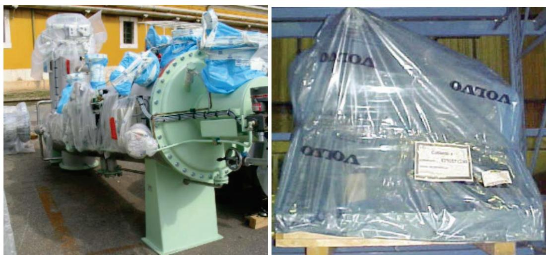
Slika 4.4 Primjena hlapljivih inhibitora korozije prilikom transporta i skladištenja [11]
