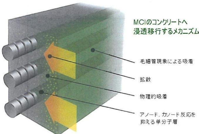
MCI の濃度は時間とともに上昇しており、これにより MCI がコンクリート内部に拡散していることが分かります (Figure 2)。実験的に得られたデータを用い、拡散係数を求めました (Figure 3 及び Table 2)。このデータは MCI が浸透移行する性質を持っていることを示し、そして腐食を誘発する塩化物や中性化に対し防錆保護できることを証明しています。
