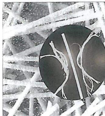
MCIを添加したポリプロピレンモノフィラメントファイバー。新設コンクリートの収縮ひび割れを減少。
