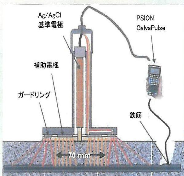
MCI の効果を評価するには、実際のコンクリート内部の鉄筋の腐食率を調べることです。未処理状態の測定をした後、MCI を塗工し再度測定します。それにより初期値がどの様な状態であったことや、防錆剤を塗工した後どれ位腐食率が落ちたのかが分かり、またいつ補修をしたら良いのかが分かります。コンクリート内部の金属の腐食率を調べるために分極抵抗法を用いた各種の機器があります。それらは Gecor 6、Gecor 8、GalvaPulse や Corrator プローブの様な埋設される腐食率センサーなどです。
