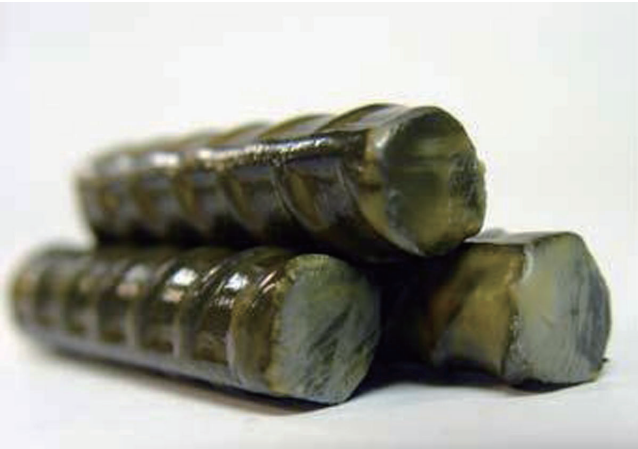
图 5 ❖ 钢筋上的不粘保护涂层在嵌入混凝土之前无需移除。
