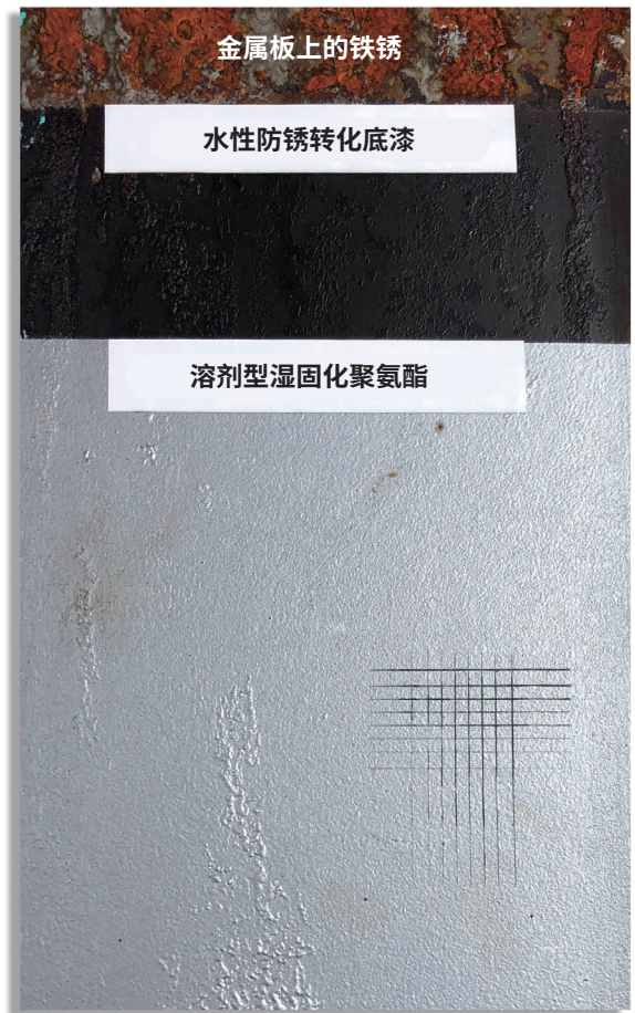
图2 ❖ CorrVerter用于带聚氨酯面漆的生锈钢板。
