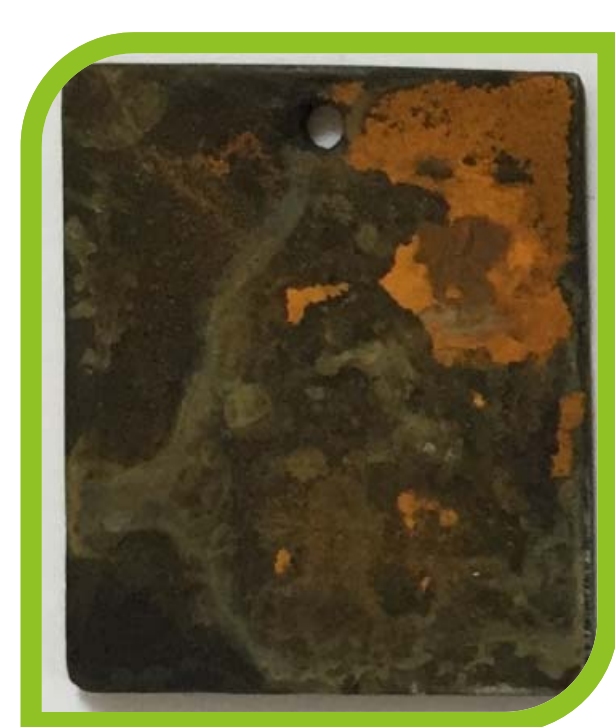
Tipični izgled čeličnih uzoraka nakon 30 dana izlaganja 3,5 % otopini NaCl: a) bez inhibitora, b) s 60 ppm inhibitora i c) s 2000 ppm inhibitora.
