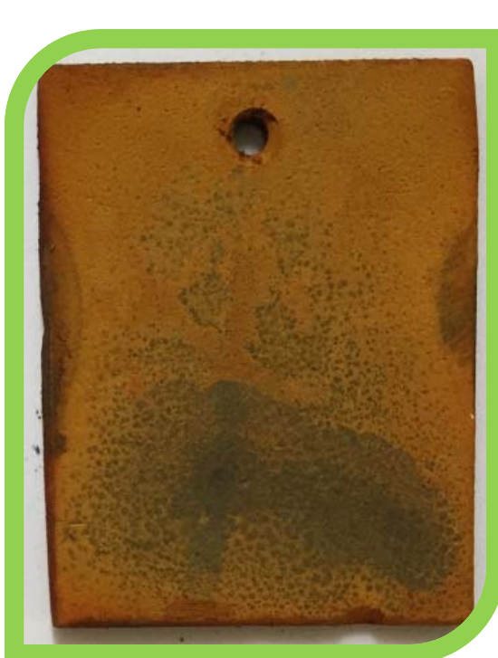
Tipični izgled čeličnih uzoraka nakon 30 dana izlaganja 3,5 % otopini NaCl: a) bez inhibitora, b) s 60 ppm inhibitora i c) s 2000 ppm inhibitora.
