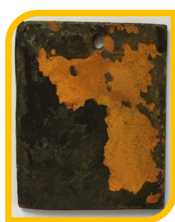
Tipični izgled čeličnih uzoraka nakon 30 dana izlaganja 3,5 % otopini NaCl: a) bez inhibitora, b) s 60 ppm inhibitora i c) s 2000 ppm inhibitora.
