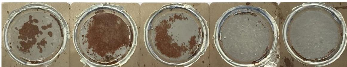
Slika 8. Tipični izgled čeličnih pločica nakon uklanjanja cilindara s betonom i izlaganja korozivnom okolišu. Redom su s lijeva na desno, prikazani su uzorak: bez klorida, s kloridima te s kloridima i inhibitorom A, B i C.
