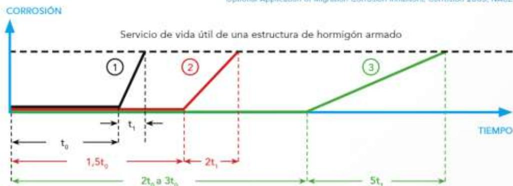
Figura No. 2: Las gráficas 1, 2 y 3 muestra la tasa de corrosión de dos estados de corrosión para un concreto sin inhibidor, inhibidor de aminoalcoholes y carboxilato de amina, respectivamente.
