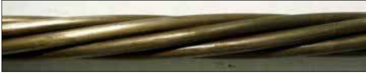
Gambar 6: Spesimen Perlakuan MCI®-309 dari Air Asin Setelah Dibersihkan (Tengah)
