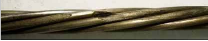
Gambar 5: Spesimen Kontrol dari Air Asin Setelah Dibersihkan (Tengah)
